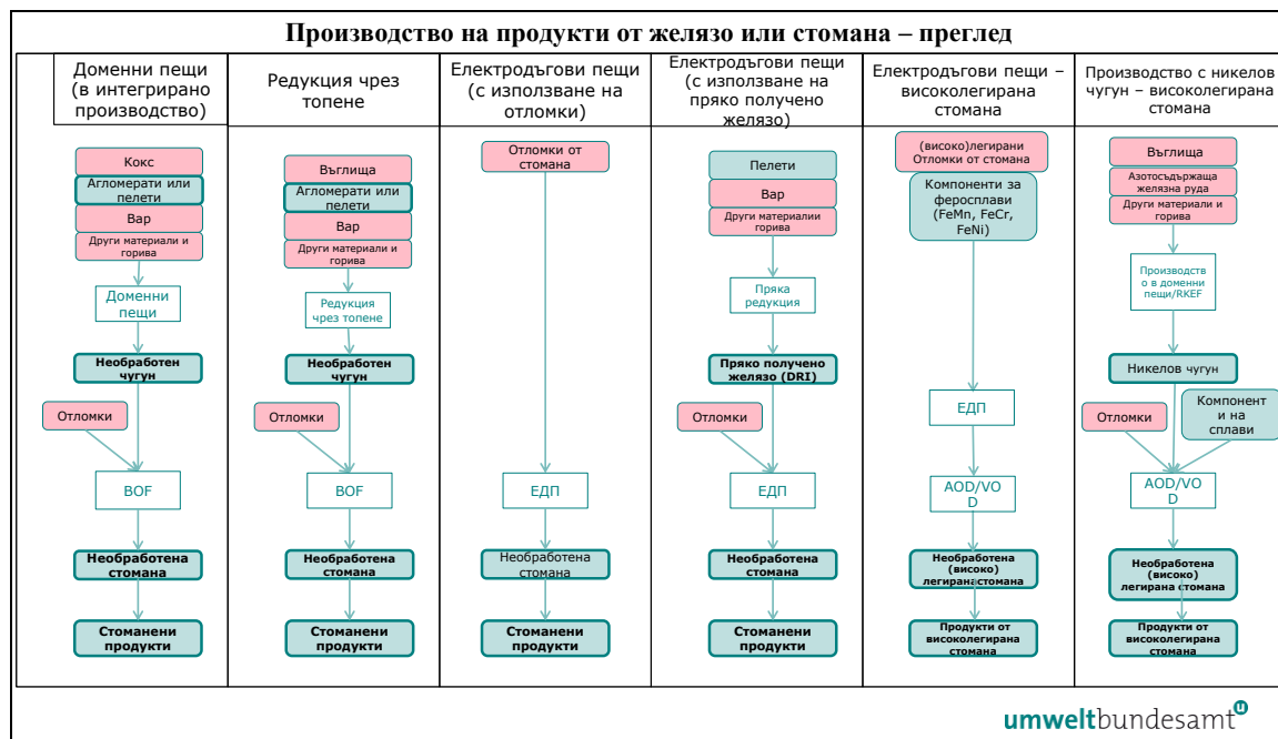
Фигура 5-5: Граници на системата и верига на стойността за производството на продукти от желязо или стомана
